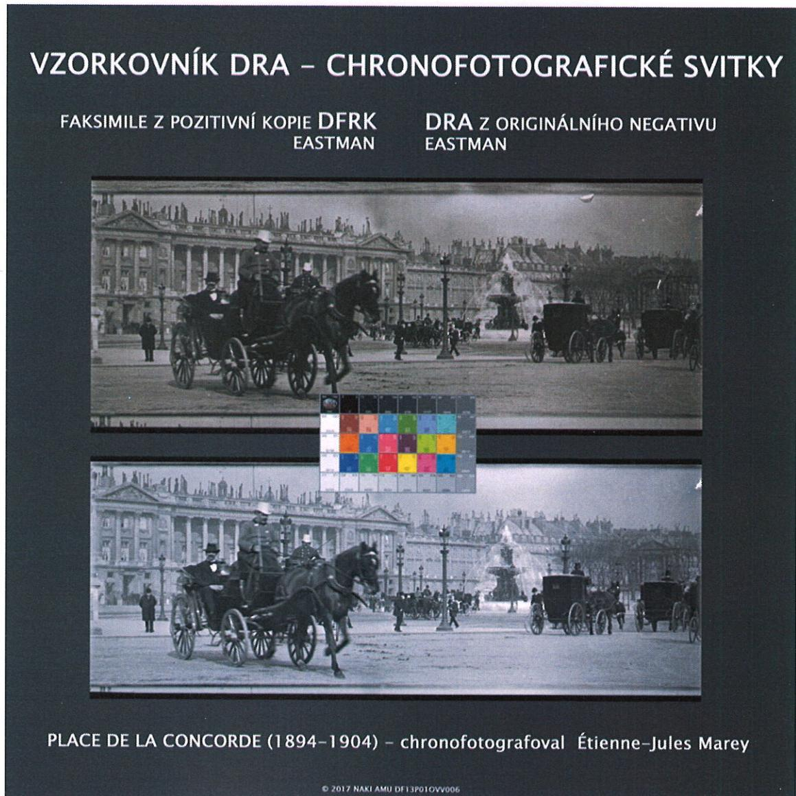
O.1.6. **TIFF TESTOVACÍ OBRAZEC** - testovací obrazec použitý pro restaurátorské práce k nastavení korektoru a projekce. Referenční obrazce použité k nastavení barevného korektoru a digitálního korektoru nebo vypalovacího laseru, v případě vzniku nového negativu z restaurovaných digitálních dat.
